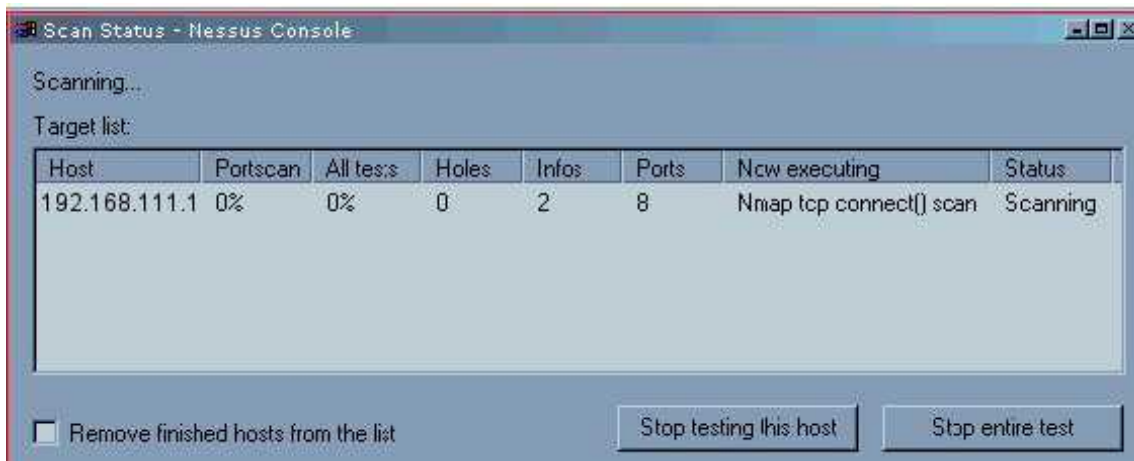
Figure 13: Déroulement du scan pour le client Nessus
